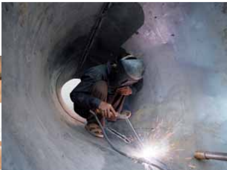
Cattivi esempi di comportamento in saldatura e taglio; da sinistra: rischio esplosione in presenza di sostanze chimiche, saldare senza protezione, mancanza di ordine e pulizia.
